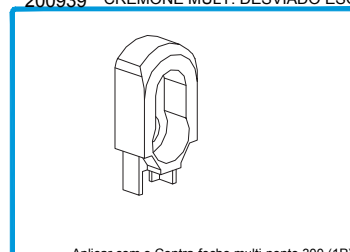
Aplicar com o Contra-fecho multi-ponto 300 (1P) 215060 PEÇA ANTI-LEVANTAMENTO MULTIPONTO 300(1P)
