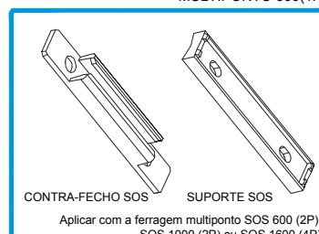
Aplicar com a ferragem multiponto SOS 600 (2P), SOS 1000 (2P) ou SOS 1600 (4P) 202094 CONTRA-FECHO MP SOS 230305 SUPORTE P/C-FECHO MP SOS
