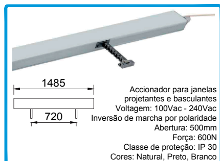
212036 ACIONADOR ELÉTRICO DUPLO 240VAC 40989D Acionador para janelas projetantes e basculantes Voltagem: 100Vac - 240Vac Inversão de marcha por polaridade Abertura: 500mm Força: 600N Classe de proteção: IP 30 Cores: Natural, Preto, Branco
